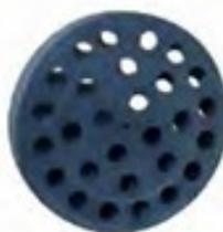
El acceso del agua al filtro se realiza a través de unos difusores especiales que infieren al agua un movimiento centrifugo, provocando un arrastre y limpieza de la malla y posterior precipitación de las partículas en suspensión, las cuales se acumulan en el depósito inferior, éste dispone de una salida.
