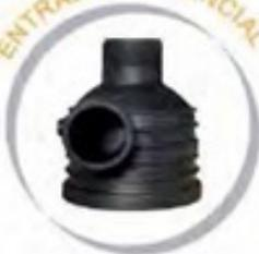
Su función es la de separar la arena y otras partículas compactas más pesadas que el agua, por lo que es ideal como filtro previo en instalaciones que captan agua de pozo o ríos etc. La separación se produce gracias a la velocidad de rotación que se genera al ser inyectada el agua de forma tangencial en el interior del cuerpo del hidrociclón o separador de arena.
