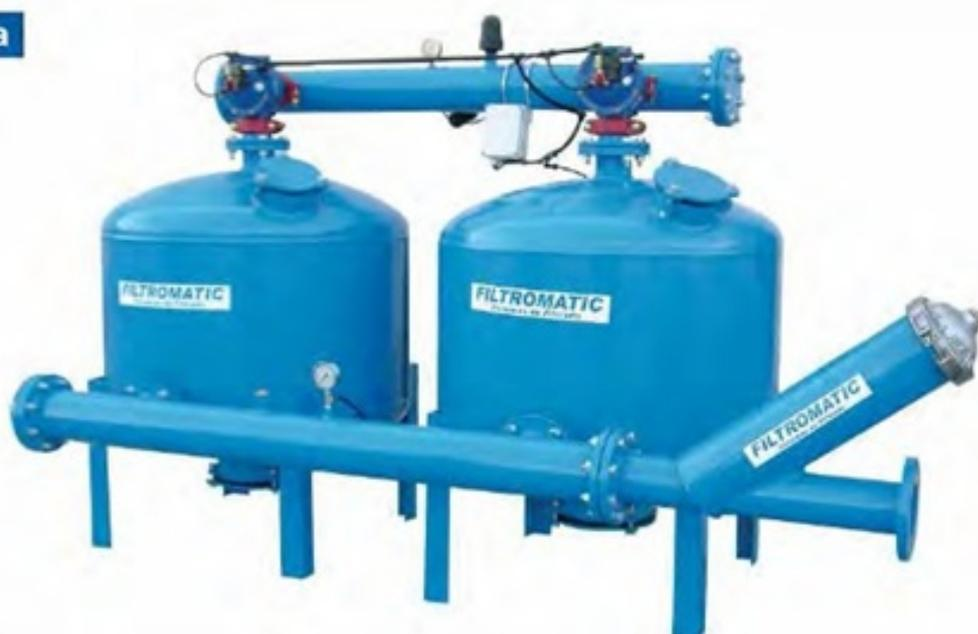
La limpieza de los cabezales se efectúa automáticamente con un programador por tiempo tiempo y un presostato diferencial por diferencia de presión.
